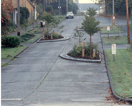
Ralentissement du trafic par la création de Chicane (Source : Wikipedia).
