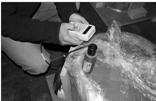
Mesure de la teneur en eau des dépôts avec la sonde ML2x de Delta-T Devices.
